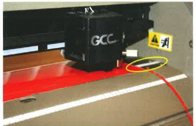
Figuur 3 - Trek de folie door, net over de witte lijn (zonder strepen erop)
