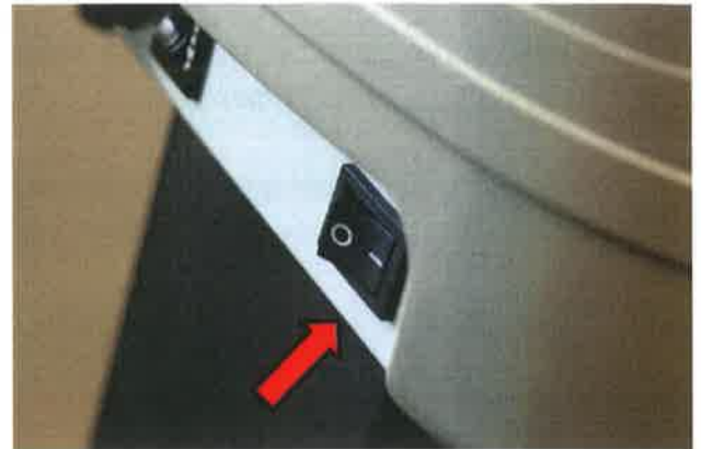
Figuur 2 - De aan/uit schakelaar aan de linkerkant van de machine
