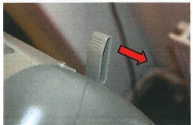
Figuur 4 - Laat de rollen zakken met de hendel achterop de machine
